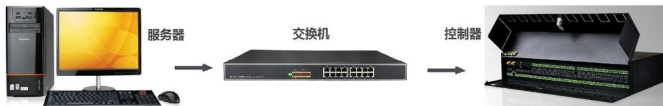
图 12: 网络连接示意图
